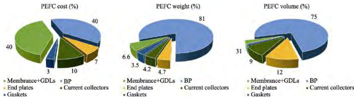
图 1 双极板在 PEMFCs 中所占成本、重量、体积比例 Fig.1 Ratio of cost, weight and volume proportion of bipolar plates in PEMFCs
